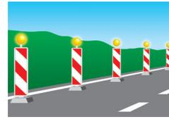
**Luces amarillas fijas o intermitentes (sobre balizas de borde provisionales):** prohíben el paso a través de la línea real o imaginaria que los une.
