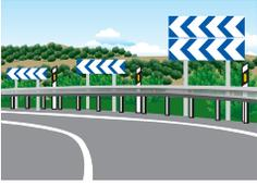
**Paneles direcciones permanentes:** su finalidad es marcar el trazado de una curva para circular por ella con mayor seguridad, además de indicar el sentido de la circulación facilitando al conductor su percepción.
