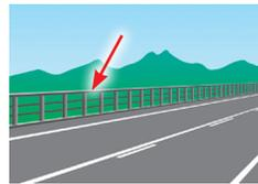
**Pretiles:** protegen frente a salidas de la vía en las zonas de tableros de puentes y obras, de paso, coronaciones de muros de sostenimiento y obras similares.
