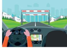
**Pórtico de control de gálibo:** estructura que sirve para advertir o impedir el paso de **vehículos que sobrepasan la altura** de una estructura ya sea puente, paso superior o túnel, que viene a continuación del sentido de circulación del vehículo.
