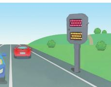
**Balizamiento circunstancial luminoso:** instalado en tramos de niebla intensa para adecuación de la distancia mínima
