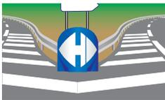
**Hito de vértice:** indica el punto en el que se separan dos corrientes de tráfico.
